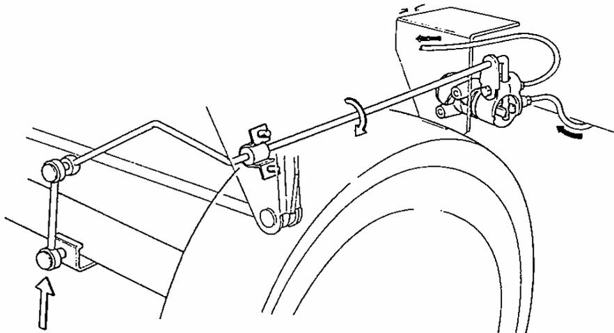
Fig. 28. - Mécanisme de commande du régulateur de freinage.
