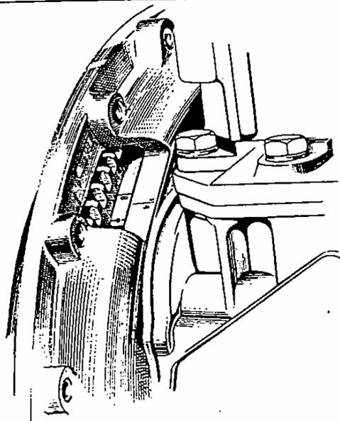
**NOTA** - Le piston n. 1 arrive au P.M.H. quand le repère  $\Phi$  frappé sur le volant moteur se trouve en face du repère 1/4 frappé sur le couvercle AR du bâti.
