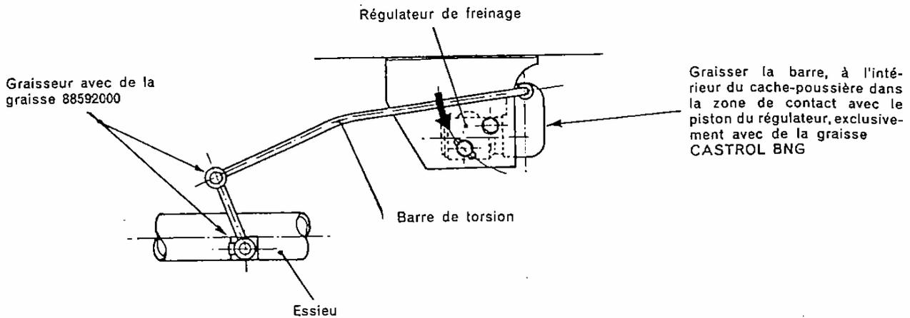
Fig. 30. - Mécanisme de commande du régulateur de freinage.
