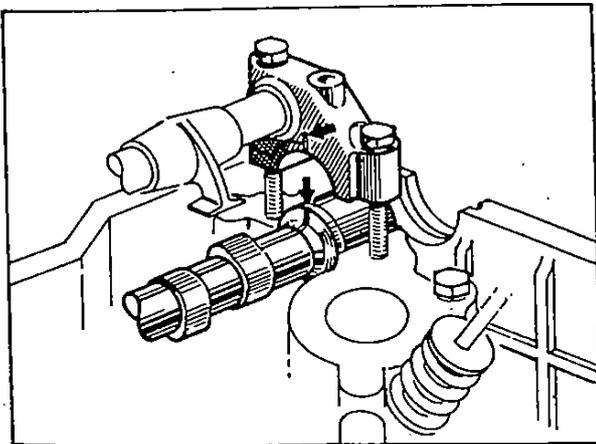
Fig. 6. - Position de montage des arbres à cames.
