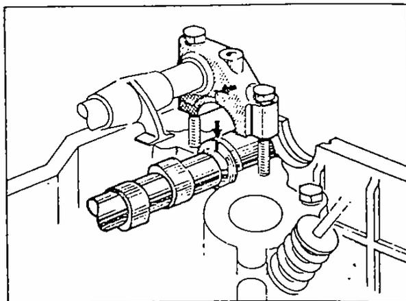
Fig. 11. - Position de montage arbres à cames.
