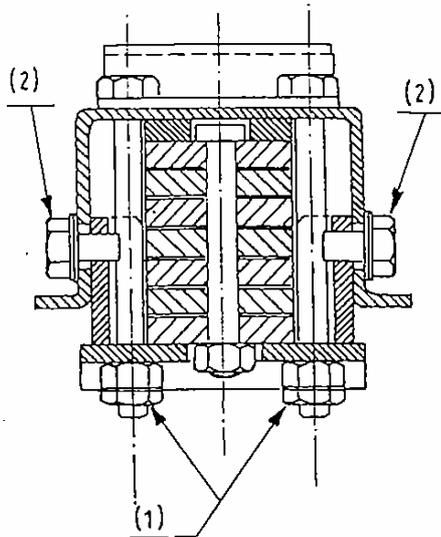
Fig. 24. - Coupe transversale du ressort à lames avant.
