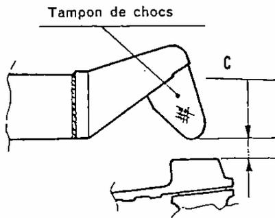
Fig. 21. - Cote entre tampon de chocs et bras supérieur.
