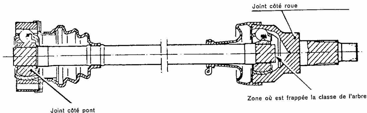
Fig. 20. - Arbre de roue avec ses joints.
