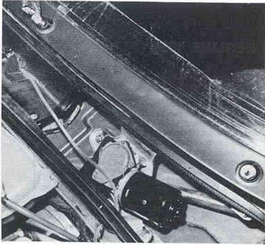
Emplacement du moteur d'essuie-glace à l'intérieur du compartiment moteur (Photo RTA)
