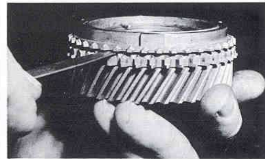
Contrôle de l'usure des synchros (Photo RTA)
