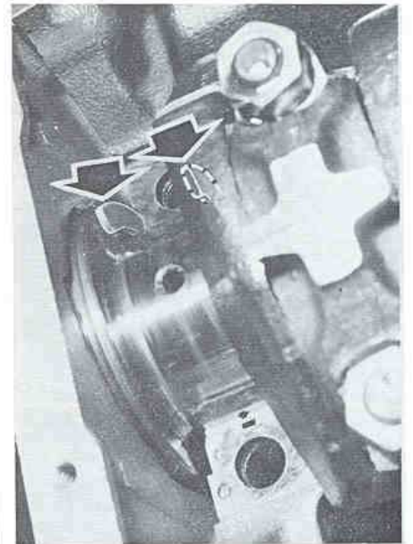
Cales (flèches) de jeu latéral du vilebrequin (Photo RTA)
