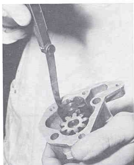
Contrôle du jeu entre pignons et corps de pompe à huile (Photo RTA)
