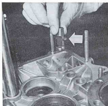
Montage des bonhommes de verrouillage à l'aide de l'outil (flèche) réf. 880.221.02 (Photo RTA)
