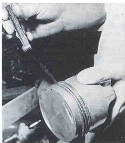
Contrôle du jeu des segments dans les gorges (Photo RTA)
