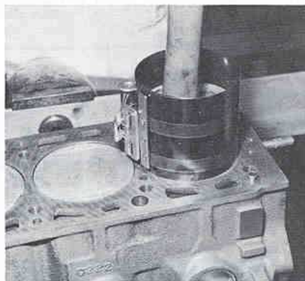
Montage des ensembles bielle-piston dans le cylindre à l'aide d'un collier à segments (Photo RTA)
