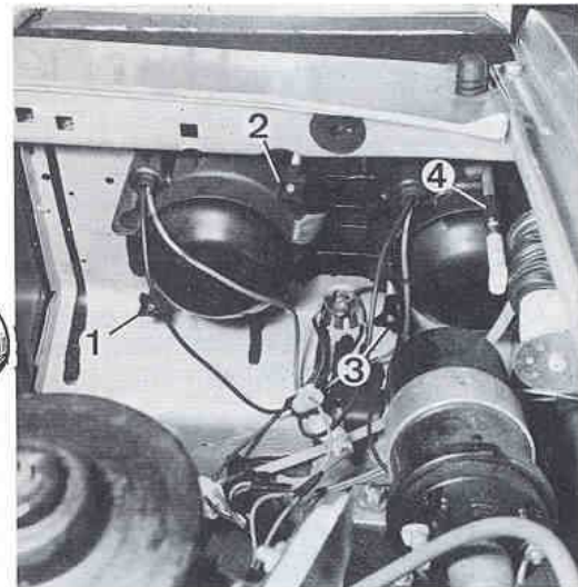
Réglage des projecteurs (optiques séparées, glace unique et correction dynamique en fonction de la charge)
