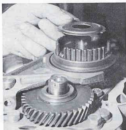
Orientation de la rondelle déflexrice (Photo RTA)
