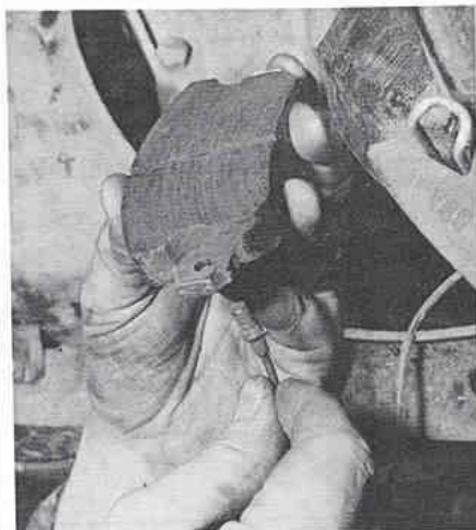
Dépose de la plaquette intérieure et débranchement du témoin d'usure (Photo RTA)
