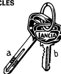
La voiture est munie de deux clés en double exemplaire, dont l'une (b) sert pour l'antivol et le contacteur à clé et l'autre (a) sert pour les serrures des portes, du couvercle de la boîte à gants, de la malle et de la trappe à essence.
