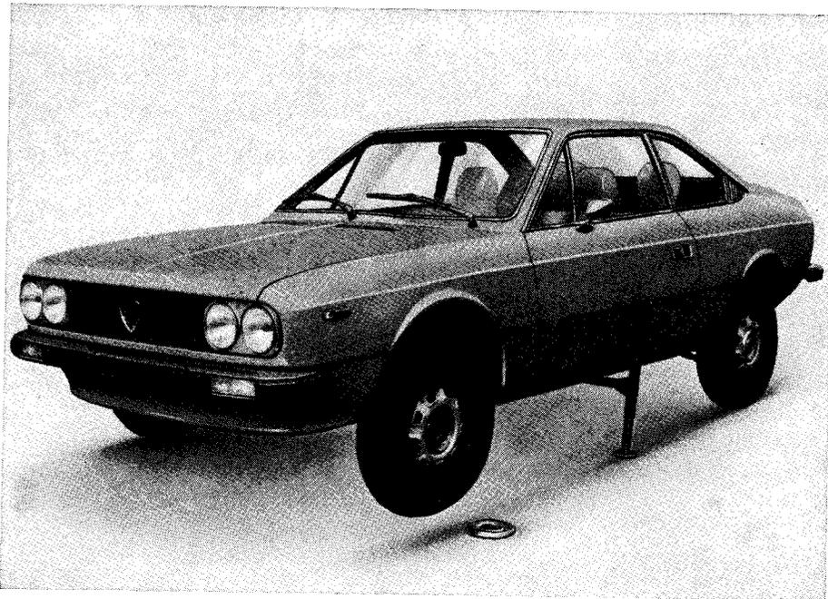
Avant de soulever la voiture, tirer le frein de stationnement pour éviter un déplacement de la voiture soulevée, du côté de la roue à remplacer. Retirer l'enjoliveur de roue et débloquer les quatre boulons qui fixent la roue.
