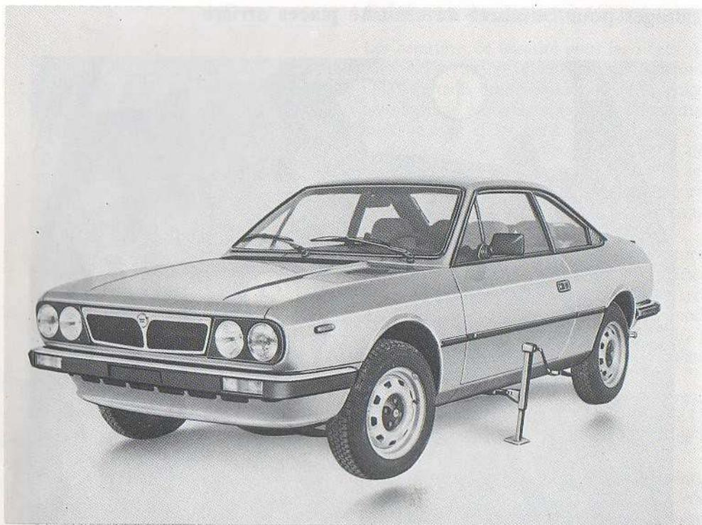
Avant de soulever la voiture, serrer le frein de stationnement et engager la première vitesse pour éviter un déplacement accidentel de la voiture en cours d'opération. Desserrer les vis de fixation. Placer le cric dans l'emplacement prévu sous le longeron, soulever la voiture, dévisser les vis que l'on vient de desserrer et déposer l'enjoliveur et la roue.
