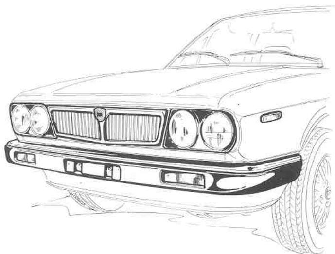
**Nouvelle calandre.** Nouveau pare-chocs avant plus enveloppant, en inox, avec profils en caoutchouc. Nouveaux entourages de couleur noire pour les projecteurs et les feux latéraux de direction.
