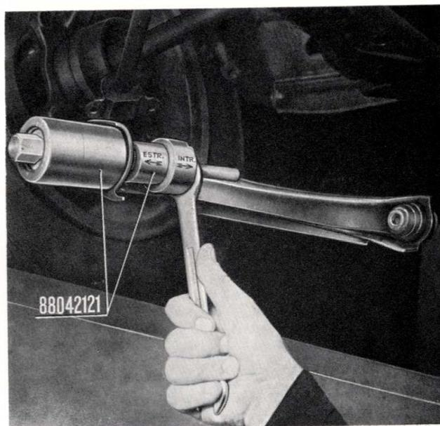
Fig. 65 - Remplacement d'un silentbloc avec l'introducteur extracteur 88042121
